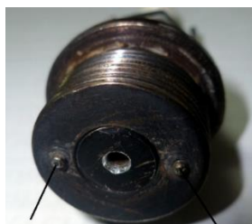
Рисунок 2.4 – Трехэлектродный ионизационный датчик
