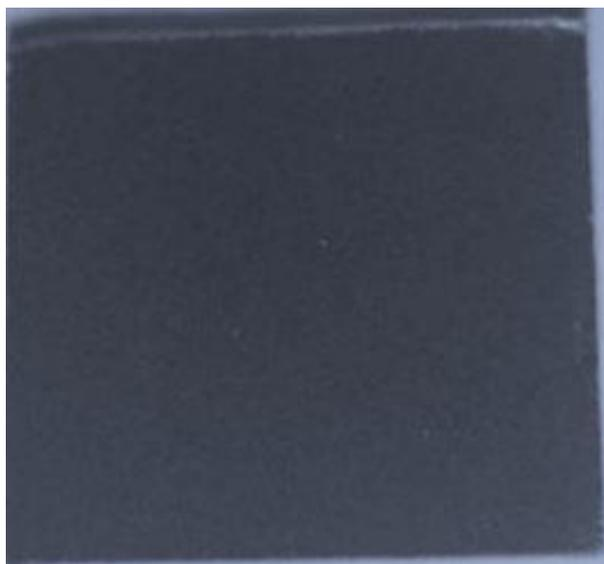
Рисунок 9 - Оксид алюминия + 40% покрытого Ti материала (Титанат алюминия)
