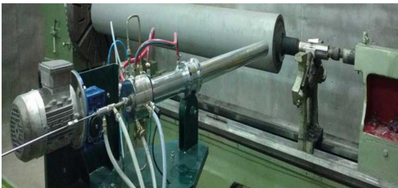
Рисунок 6 - Распыление детонирующего пистолета
