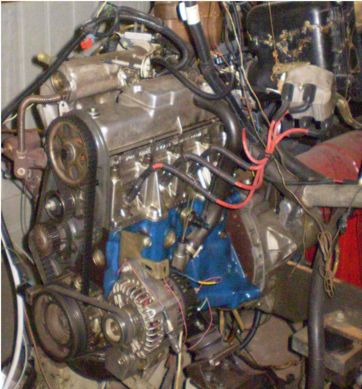
Рисунок 2.2 – Внешний вид двигателя ВАЗ-2111
