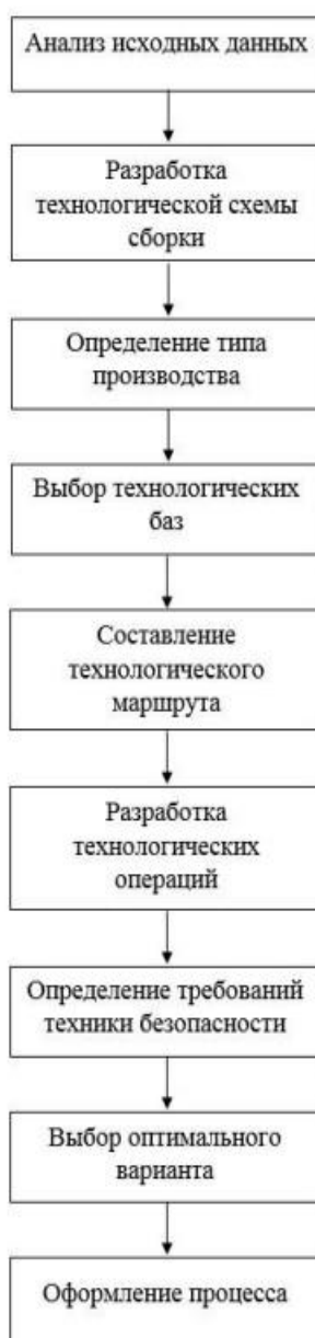
Рисунок 2 – Алгоритм разработки технологического процесса сборки
