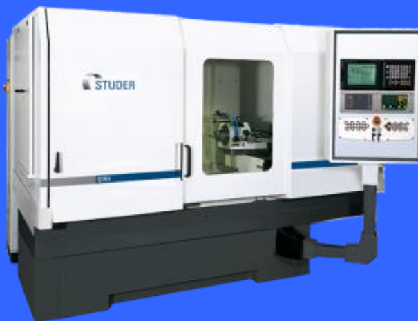
Рисунок 9 - Внешний вид внутришлифовального станка STUDER S151
