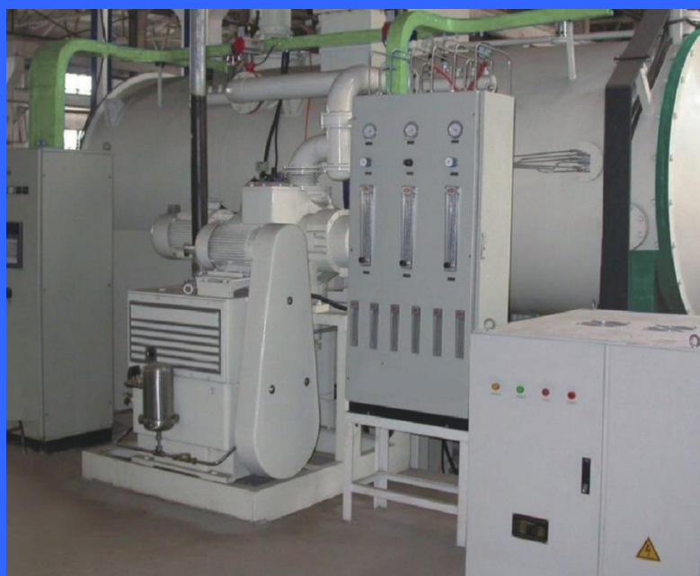
Рисунок 8 - Внешний вид вакуумной печи VCV-7710
