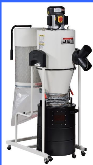
Рисунок 15 – Внешний вид промышленного пылеуловителя
