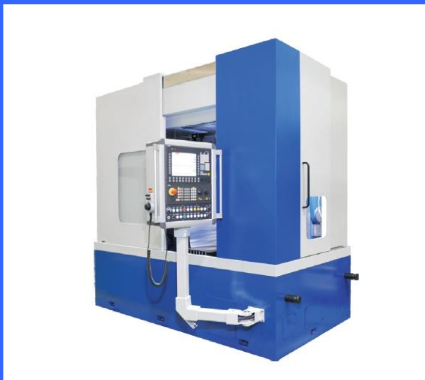
Рисунок 10 - Внешний вид внутришлифовального станка УК7380
