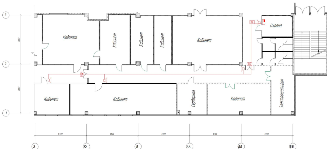
Рисунок 4 – Проект системы речевого оповещения при пожаре
