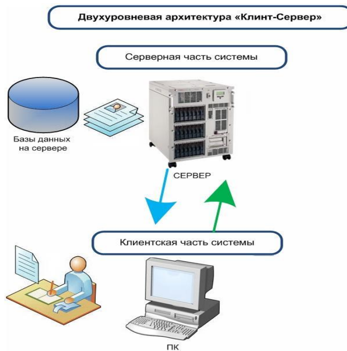
Рисунок 3.10 - Двухуровневая архитектура разрабатываемого проекта
