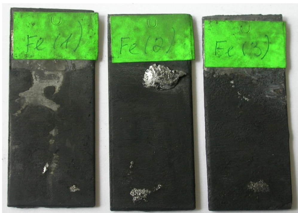
Рисунок. 3.27 – Внешний вид образцов после алитирования в расплаве Al+5%Fe
