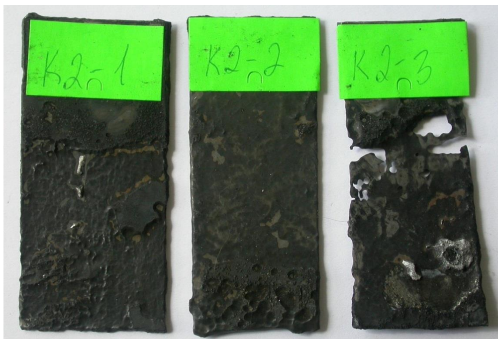
Рисунок 3.29 – Внешний вид образцов после алитирования в расплаве Si 6%
