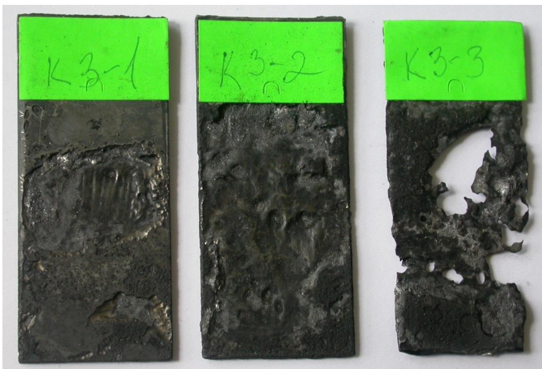
Рисунок 3.30 – Внешний вид образцов после алитирования в расплаве Si 12%
