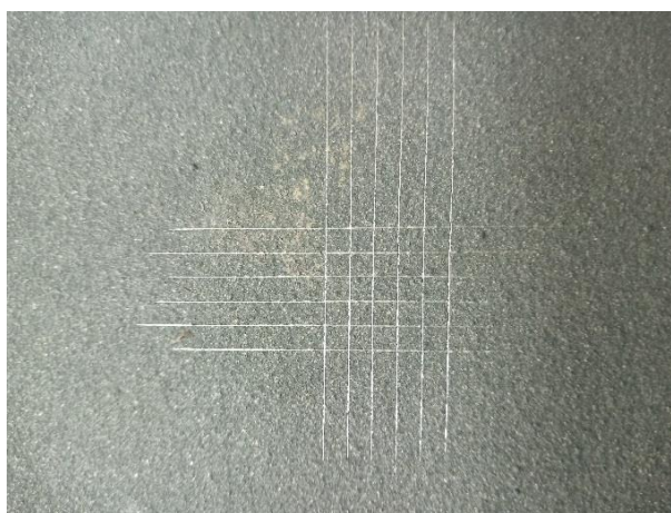
Рисунок 3.7 - Внешняя характеристика результата сцепления покрытия образца №3 путем нанесения сетки царапин
