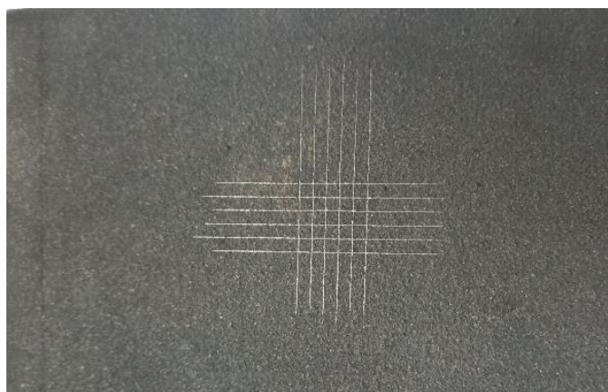
Рисунок 3.8 - Внешняя характеристика результата сцепления покрытия образца №4 путем нанесения сетки царапин
