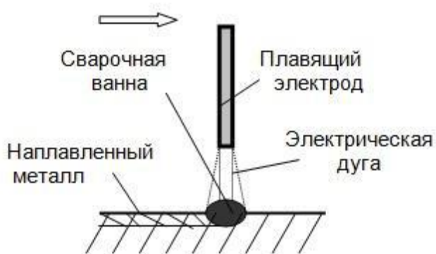
Рисунок 1.8 - Принцип наплавки в среде защитных газов. [17]
