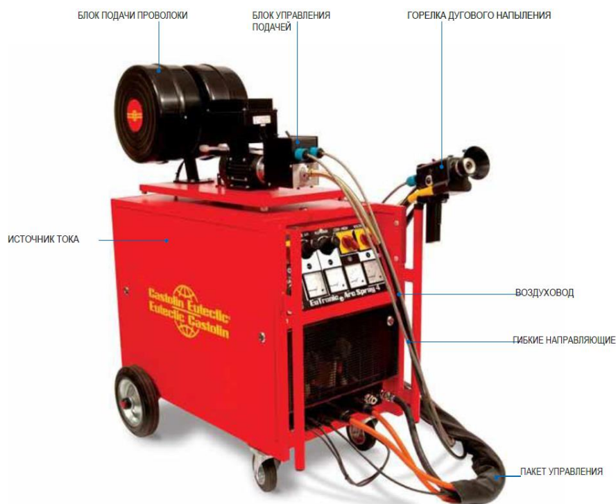
Рисунок 2.3 - Установка электродуговой металлизации EuTronic Arc Spray 4. [1]
