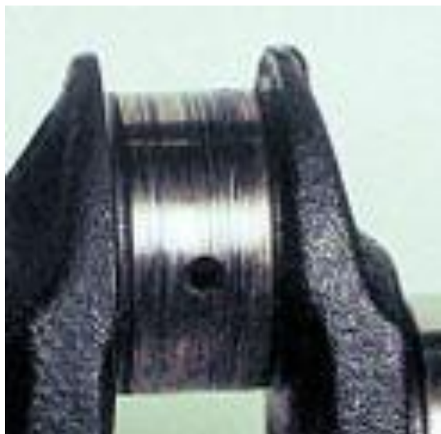
Рисунок 1.2 - Задир на шатунной шейке
