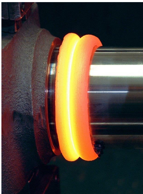
Рисунок 1.8 – Общий вид соединения получаемого сваркой трением
