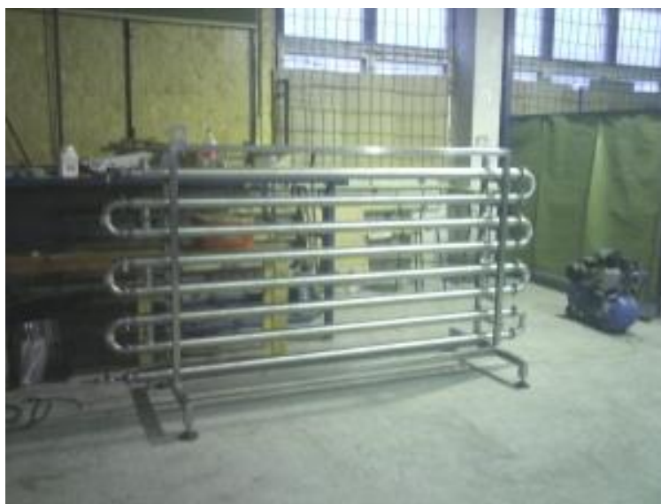
Рисунок 1.1 – Однопоточный неразборный теплообменник типа ТТОН
