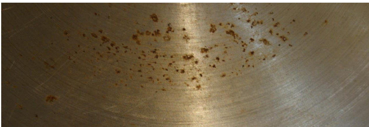
Рисунок 1.3 – Питинговая коррозия днища мешалки
