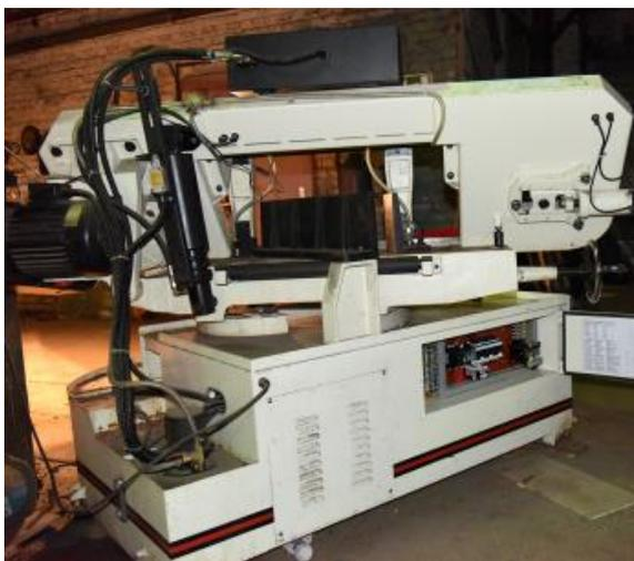
Рисунок 1.3 – Лентопильный станок JET MBS-1321VS
