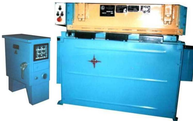
Рисунок 1.2 – Резка листовых заготовок на ножницах НД3312Б
