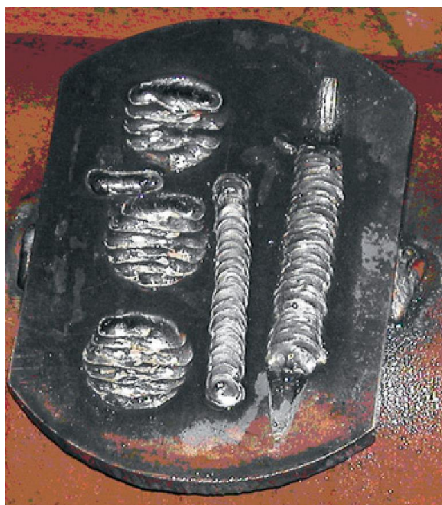
Рисунок 2.7 – Натурный образец наплавочных швов, выполненных установкой УПСС-1
