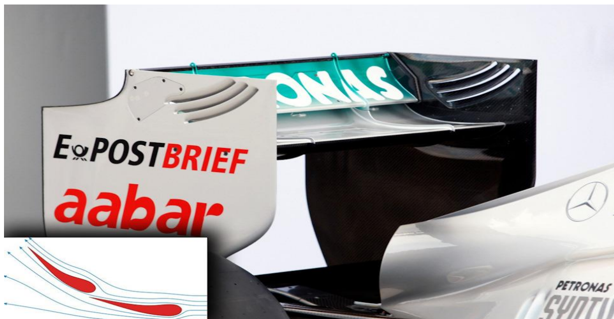
Рисунок 11 – заднее антикрыло спортивного болида
