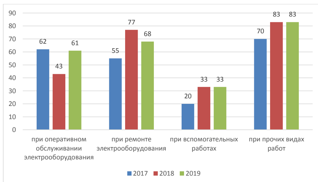
Рисунок 2.7 – Статистика травматизма электромонтеров в АО «Сызранский НПЗ»
