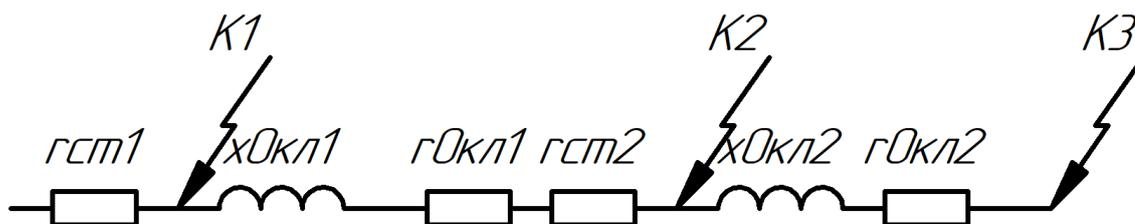
Рисунок 6.3 – Схема замещения для расчета токов однофазного КЗ
