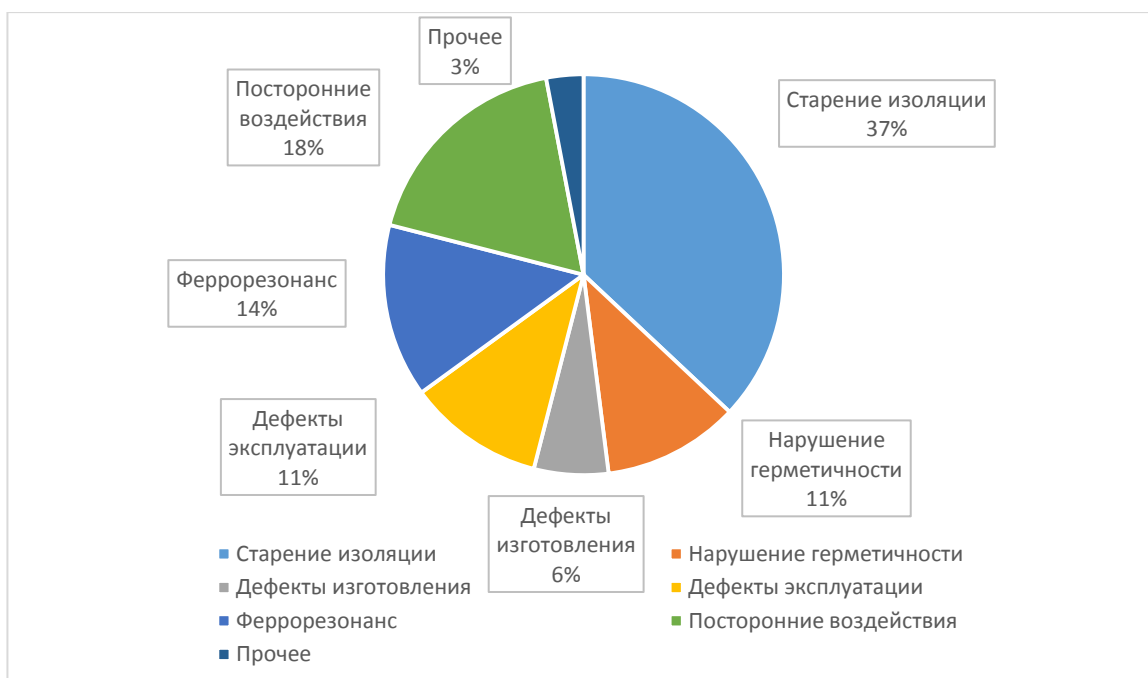
Рисунок 1.13 – Причины повреждения трансформаторов напряжения
