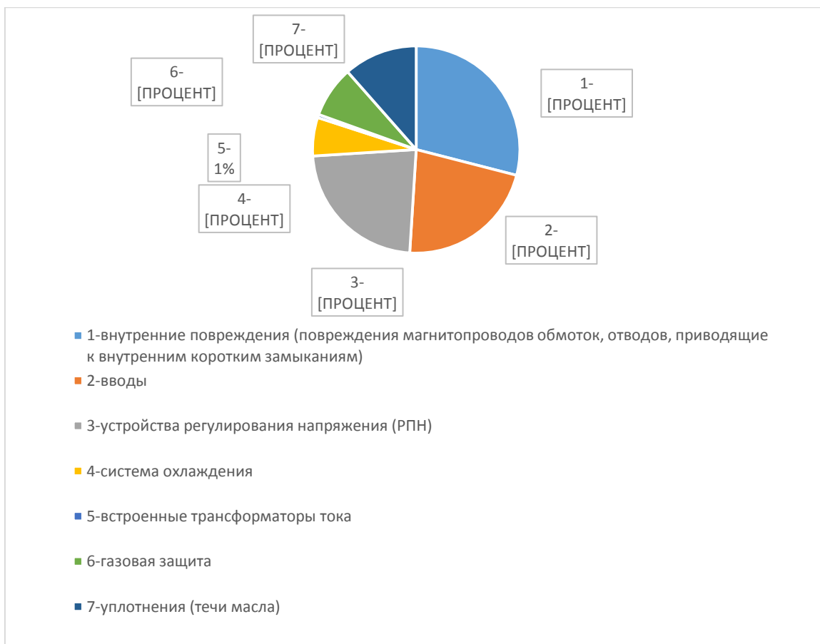
Рисунок 1.8 – Количество повреждений основных узлов силовых трансформаторов
