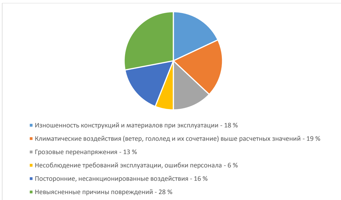
Рисунок 1.4 – Причины повреждений на ВЛ 6-20 кВ
