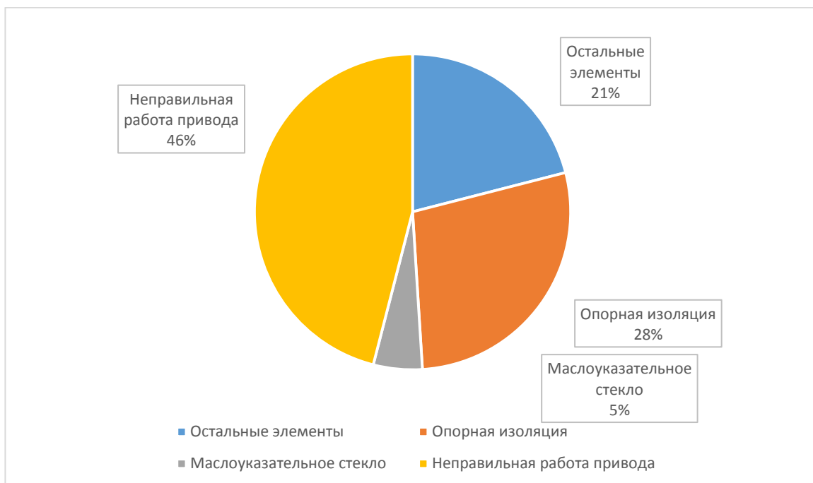
Рисунок 1.20 – Причины повреждений маломасляных выключателей
