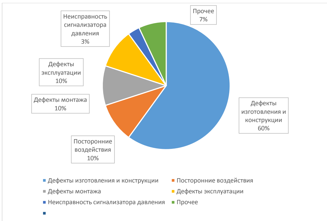
Рисунок 1.16 – Причины повреждений элегазовых трансформаторов тока
