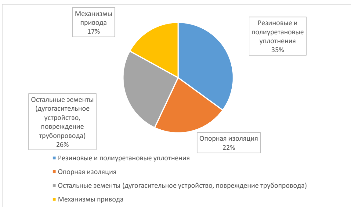
Рисунок 1.19 – Причины повреждений воздушных выключателей
