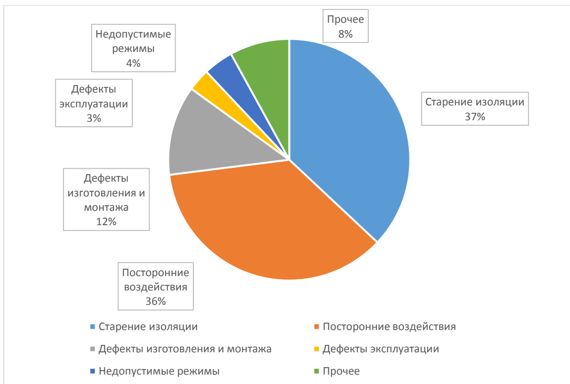
Рисунок 1.15 – Причины повреждений маслонаполненных трансформаторов тока
