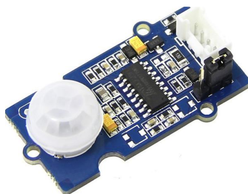
Рисунок 3.1.4 - Пирозлектрический инфракрасный датчик движения Grove - PIR Motion Sensor
