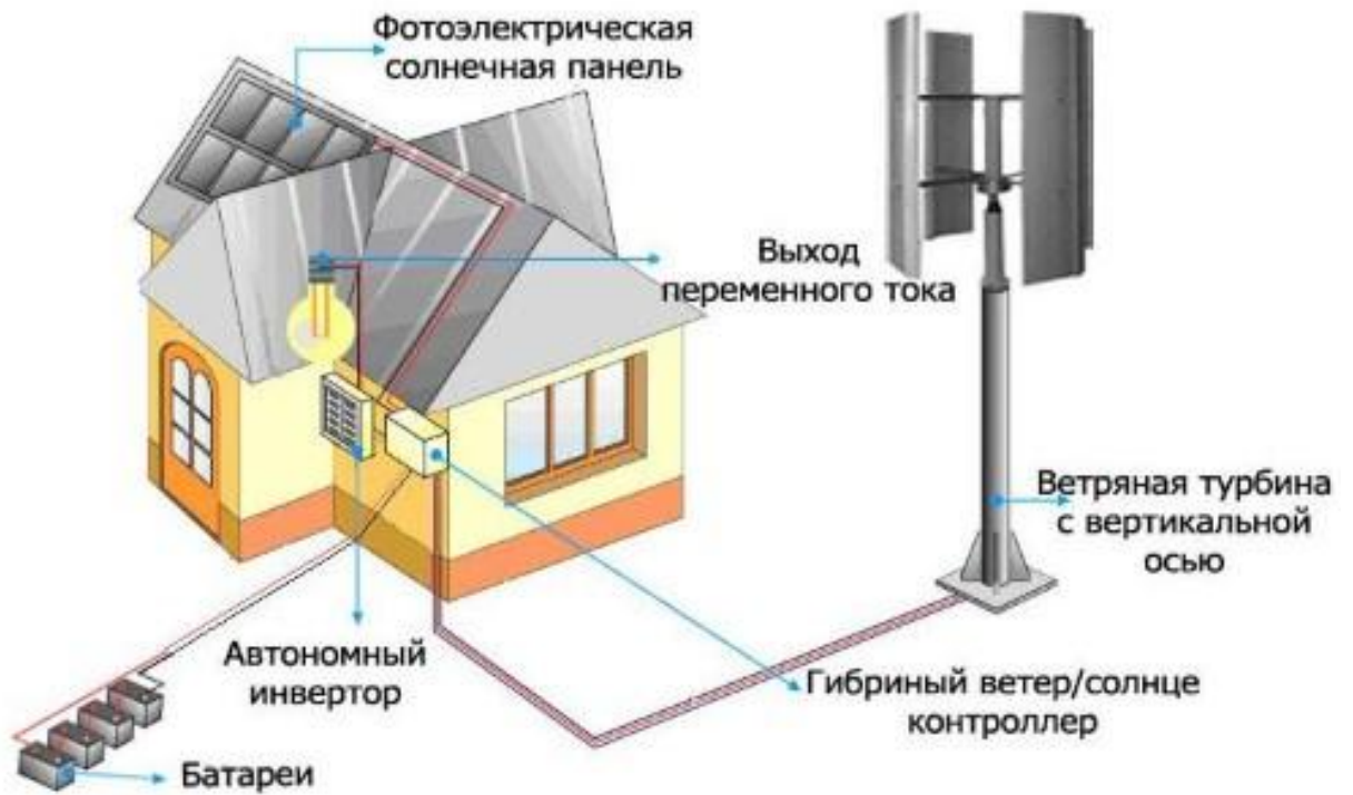
Рисунок 18 - Совместная работа ветряного генератора и солнечных панелей
