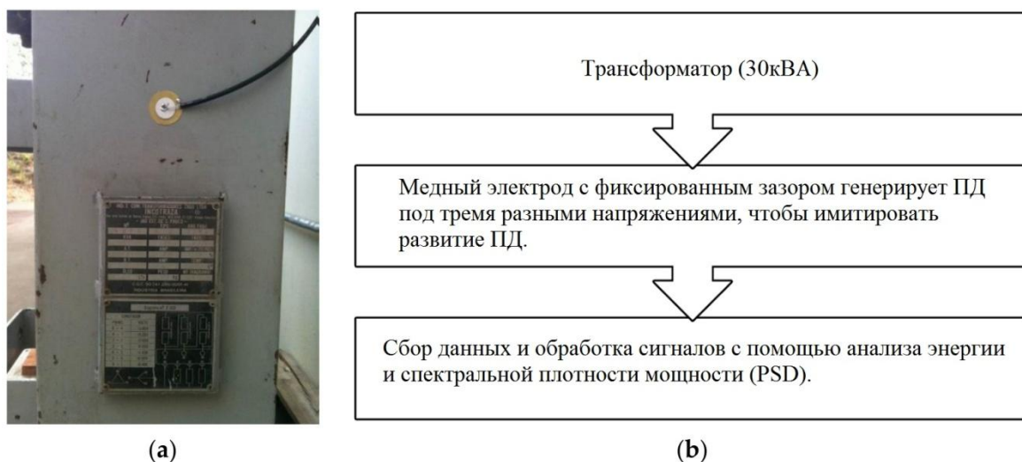
Рисунок 9 - (а) Датчик, соединенный с трансформатором; (б) принципиальная схема процедуры эксперимента.
