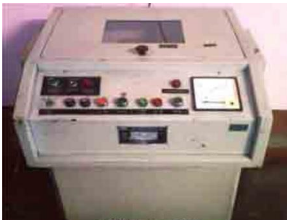
Рисунок 18 - Внешний вид установки для тестирования трансформаторного масла на диэлектрическую прочность.
