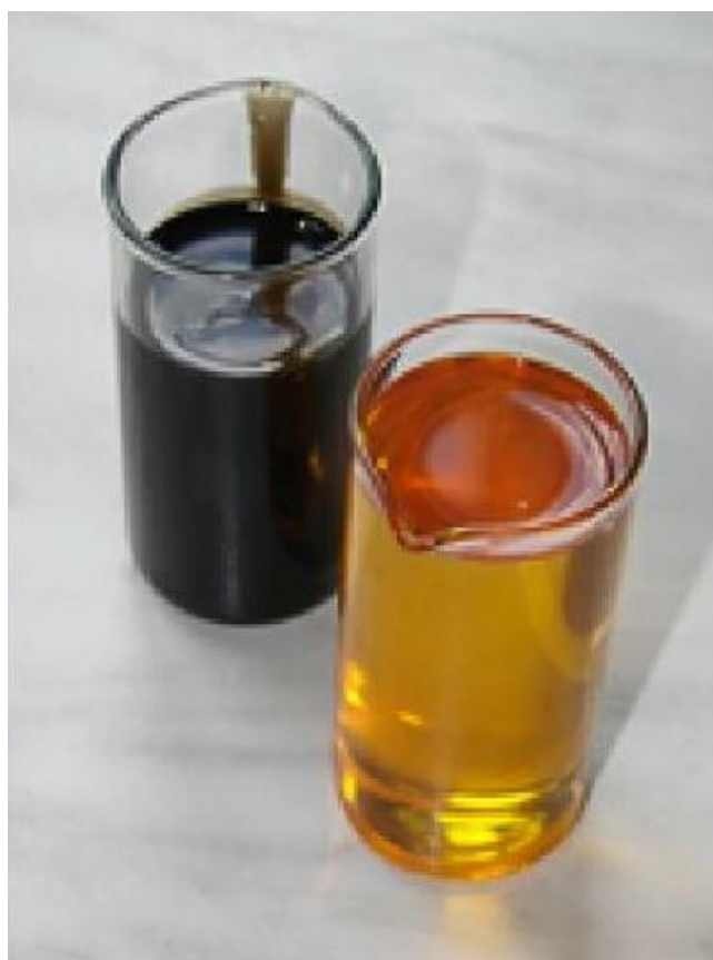
Рисунок 20 - Проба чистого трансформаторного масла(справа) и отработанного(слева)
