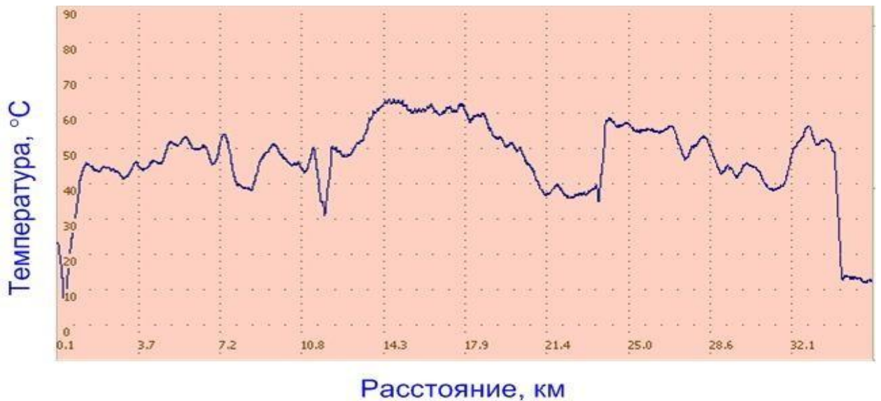
Рисунок 8 – График распределения температуры по его длине ВЛ
