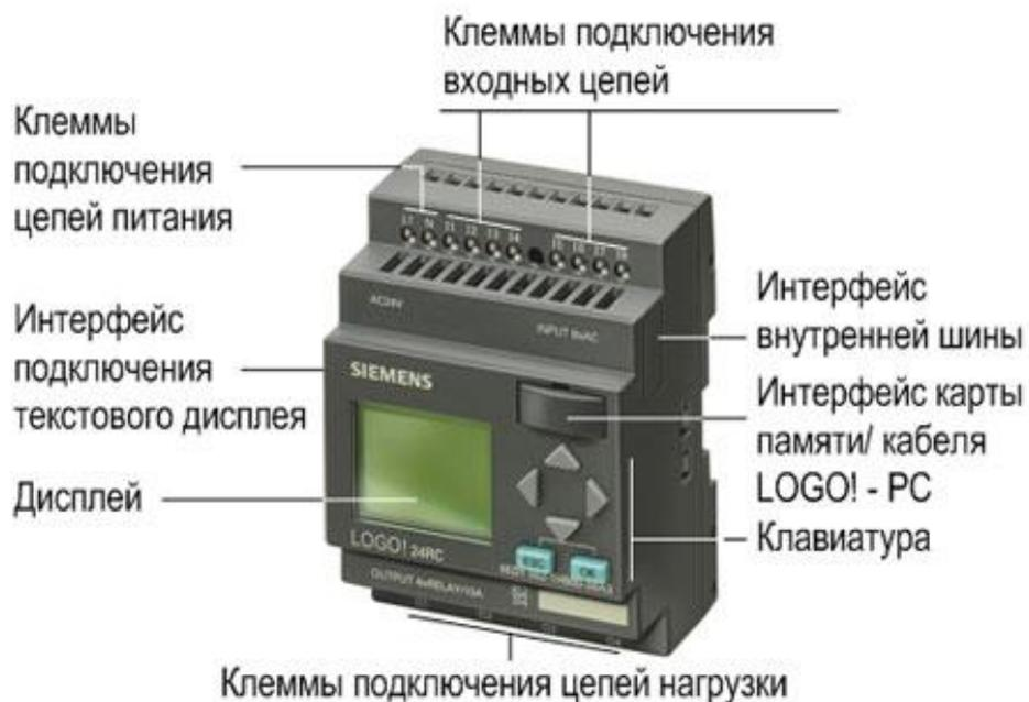
Рисунок 4 – Конструкция модуля Siemens Logo 230 RC
