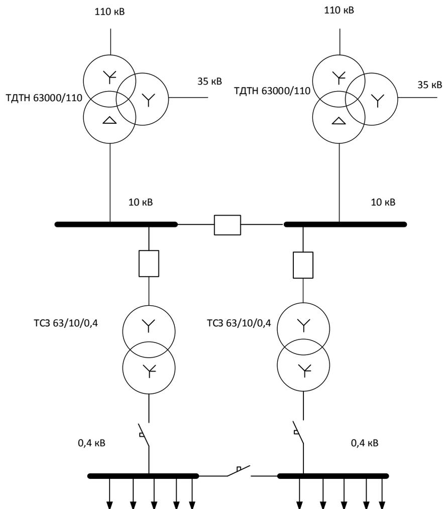
Рисунок 6.1 – Подключение ТСН
