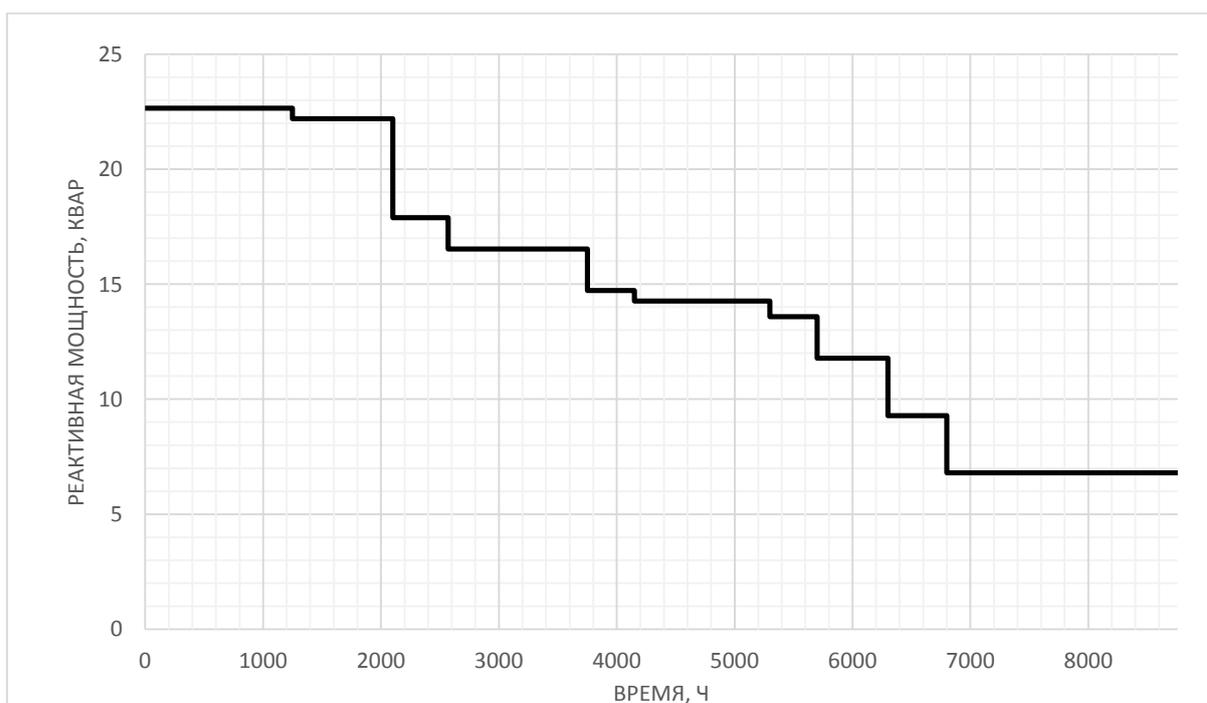
Рисунок 2.3 – Годовой график реактивной мощности подстанции
