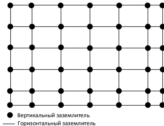
Рисунок 7.1 – Схема расположения горизонтальных и вертикальных заземлителей
