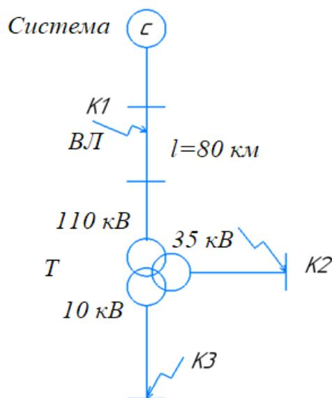
Рисунок 3.1 – Расчетная схема для расчета КЗ
