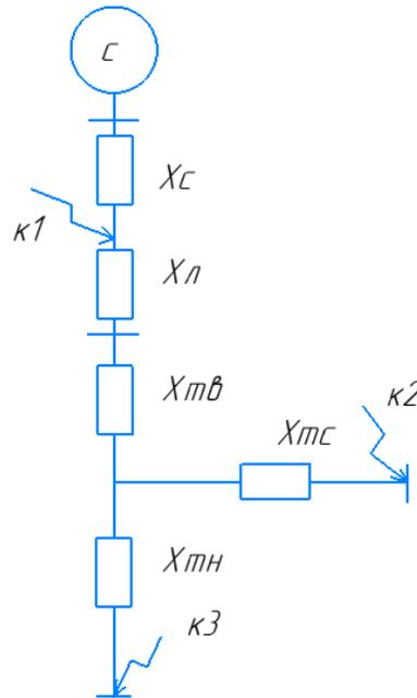
Рисунок 3.2 – Схема замещения для расчета КЗ
