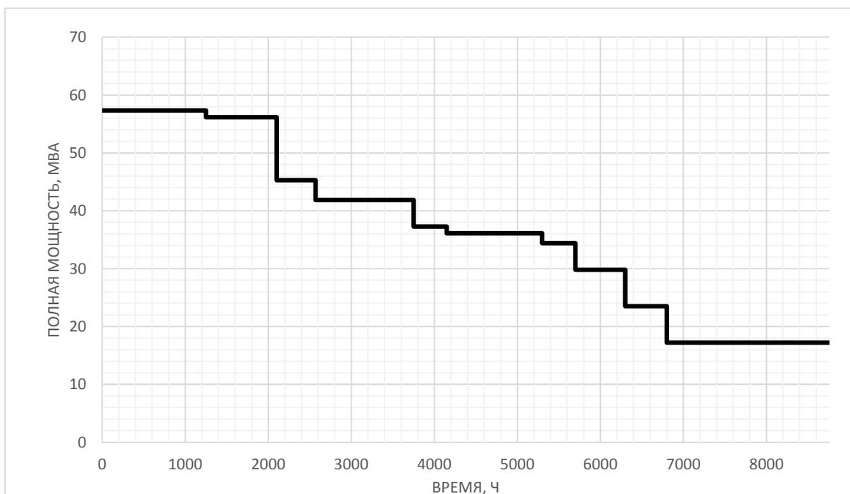
Рисунок 2.1 – Годовой график полной мощности подстанции «Ермаковская»
