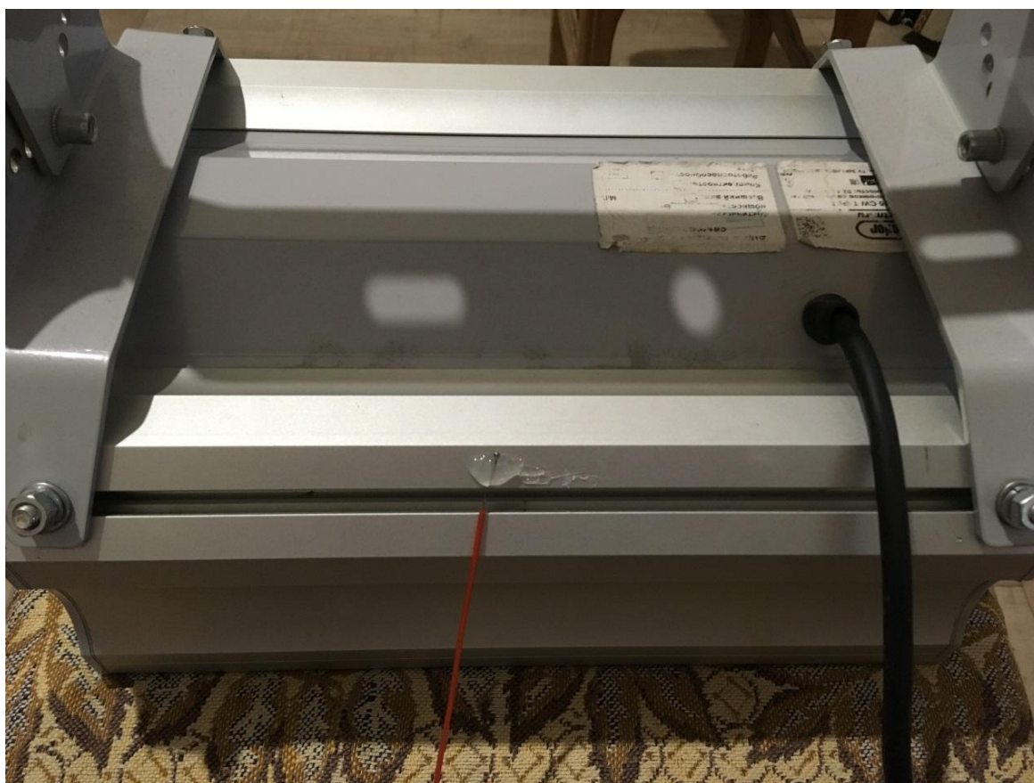
Рисунок 45 – Крепление термопары на корпусе светильника
