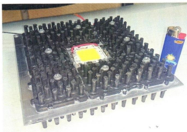
Рисунок 15 – а) кластер, закрепленный на алюминиевой пластине; б) игольчатые модульные охладители
