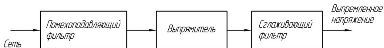
Рисунок 2 – Входной блок импульсного источника питания
