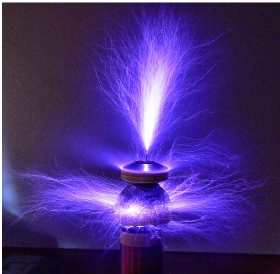
Рисунок 4 – Коронный разряд на конце одного электрода
