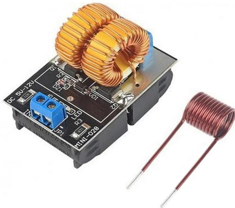
Рисунок 5.2 – устройство для индукционного нагрева металлических изделий небольшого диаметра
