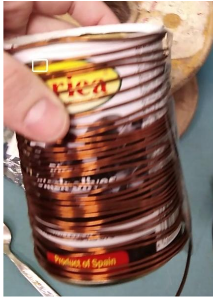
Рисунок 5.3 – кружка с обмоткой, являющаяся нагрузкой устройства для высокочастотного нагрева
