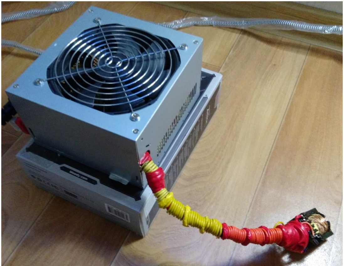
Рисунок 35. Блок питания с выведенным наружу трансформатором Для определения температуры масла будем использовать довольно просто мультиметр IEK Universal M838.
