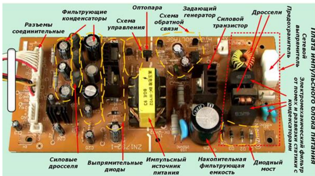
Рисунок 7. Плата импульсного ИП
