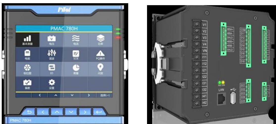
Рисунок 1.4. – Внешний вид лицевой поверхности и разъемов для подключения к измеряемым цепям анализатора показателей качества электрической энергии РМАС780Н.
