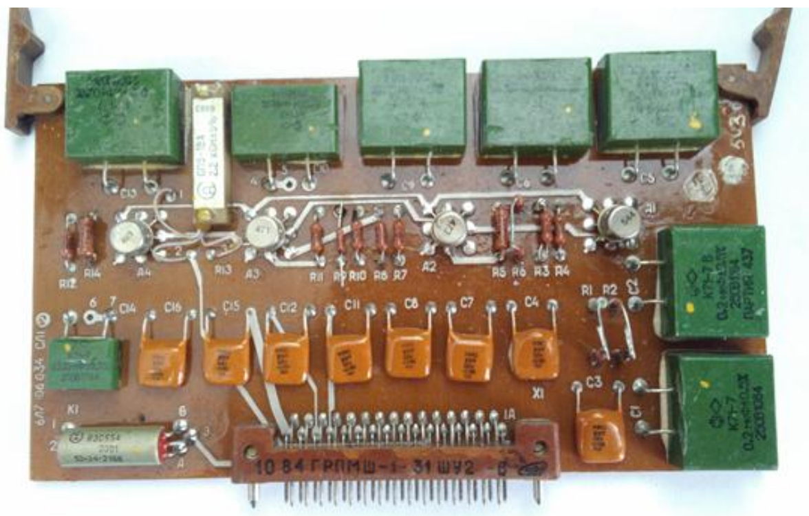
Рисунок 2.8 – Плата полосового фильтра 4-го порядка после модернизации.
