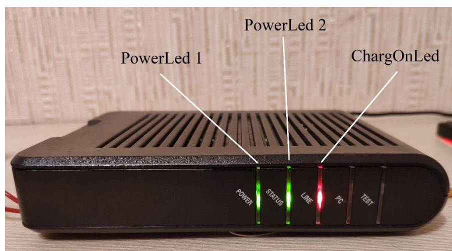
Рисунок 43 - Передняя панель СКД с индикаторами.
