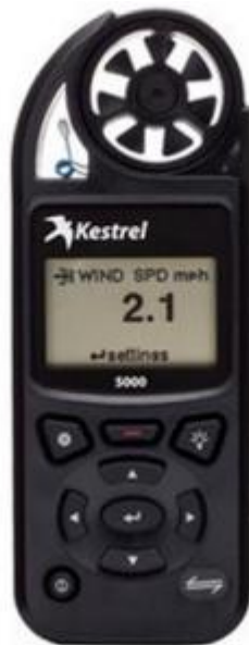
Рисунок 2 – фотография метеостанции Kestrel 5000
