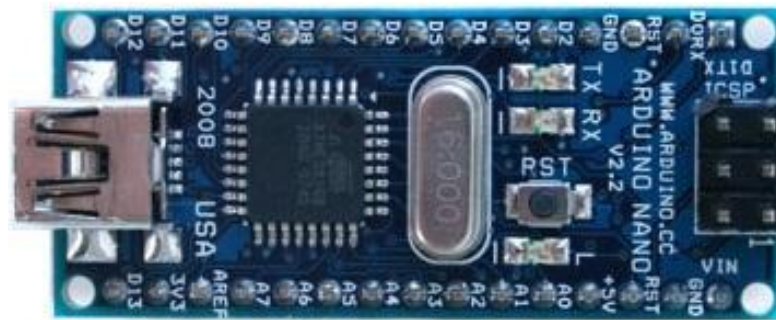
Рисунок 7 - фотография оригинальной Arduino Nano v2.2
