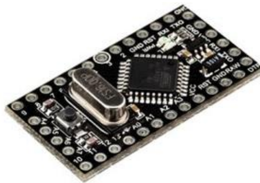
Рисунок 8 - фотография Arduino Pro Mini
