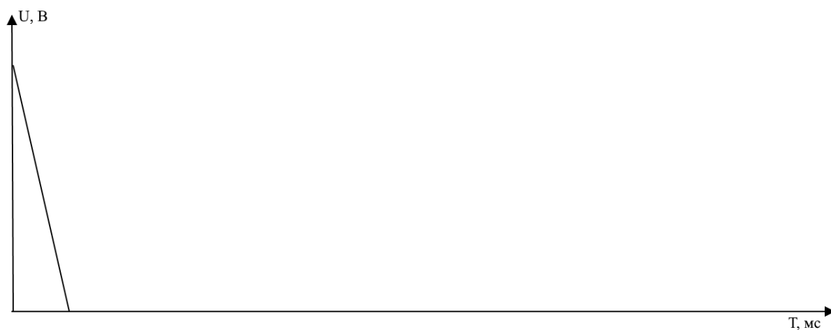
Рисунок 2.5 — График измененного при помощи дифференцирующей цепи сигнала в точке 2
