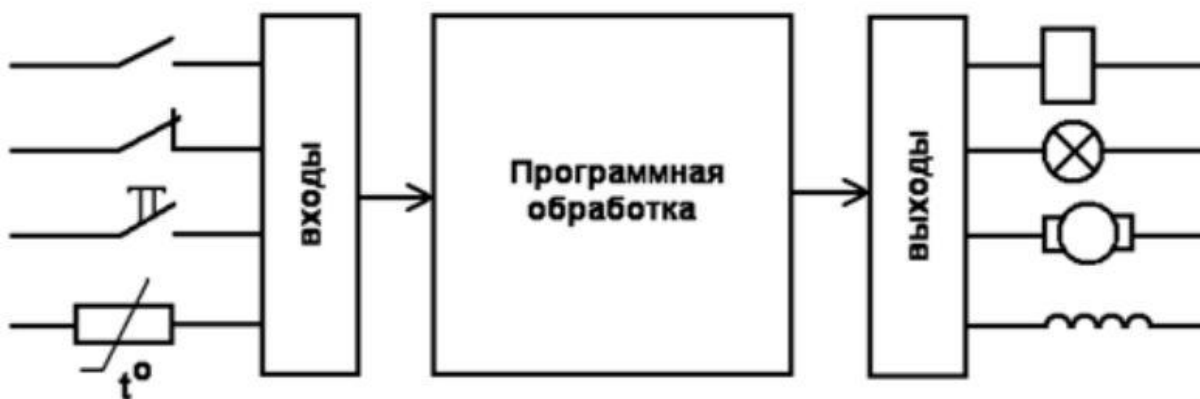
Рисунок 5.5 – Принцип работы ПЛК
