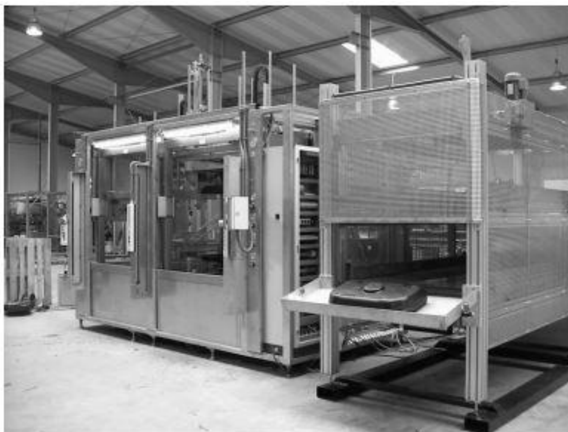
Рисунок 3.4 – Транспортная лента, соединенная с ванной охлаждения Пресс вырубной П20А.
