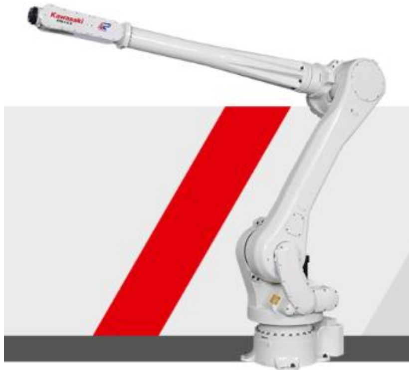
Рисунок 3.3 – Промышленный робот Kawasaki RS015X
