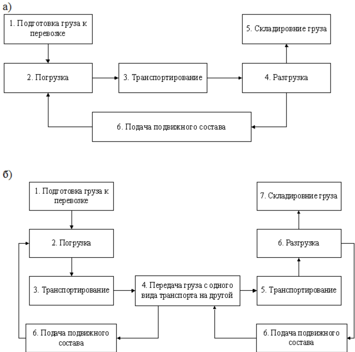
Рисунок 2 – Типовые схемы транспортно-логистического процесса при перевозке одним (а) и двумя (б) видами транспорта
