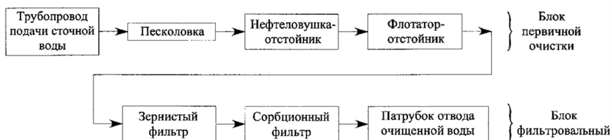
Рисунок 1 – Принципиальная технологическая схема очистки сточных вод
