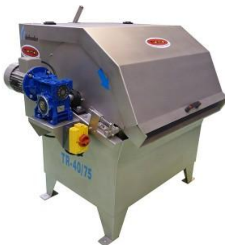
Рисунок 9 – Барабанное сито серии TR
