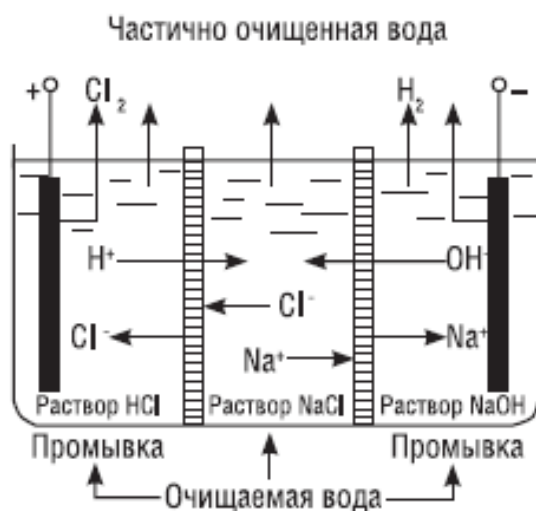
Рисунок 8 – Схема изменения концентрации растворов в ячейках трехкамерного аппарата для электрохимического обессоливания воды
