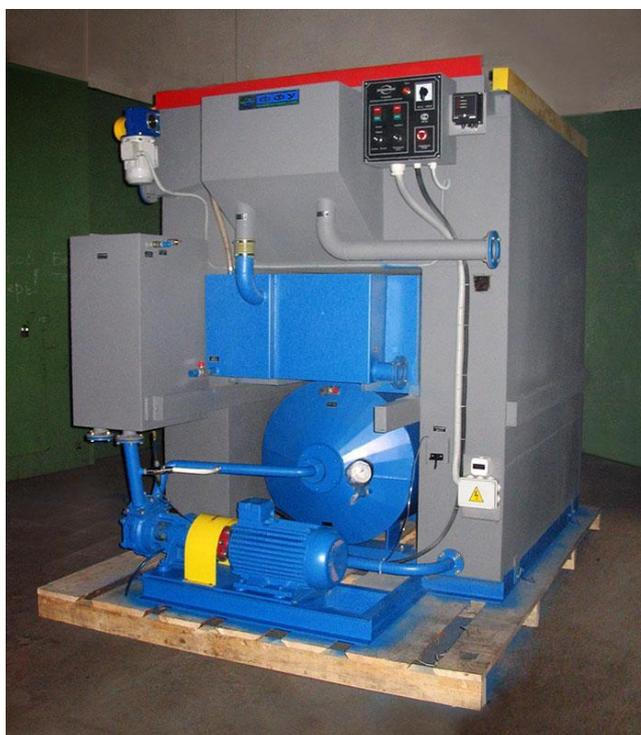
Рисунок 2.17 – Флотационно-фильтрационная установка ФФУ-1М
