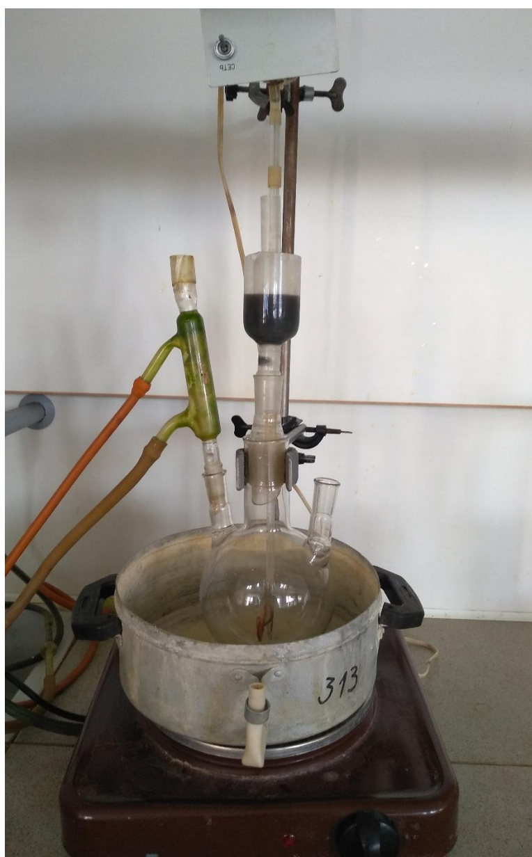
Рисунок 5.1 – Лабораторная установка синтеза смол.
