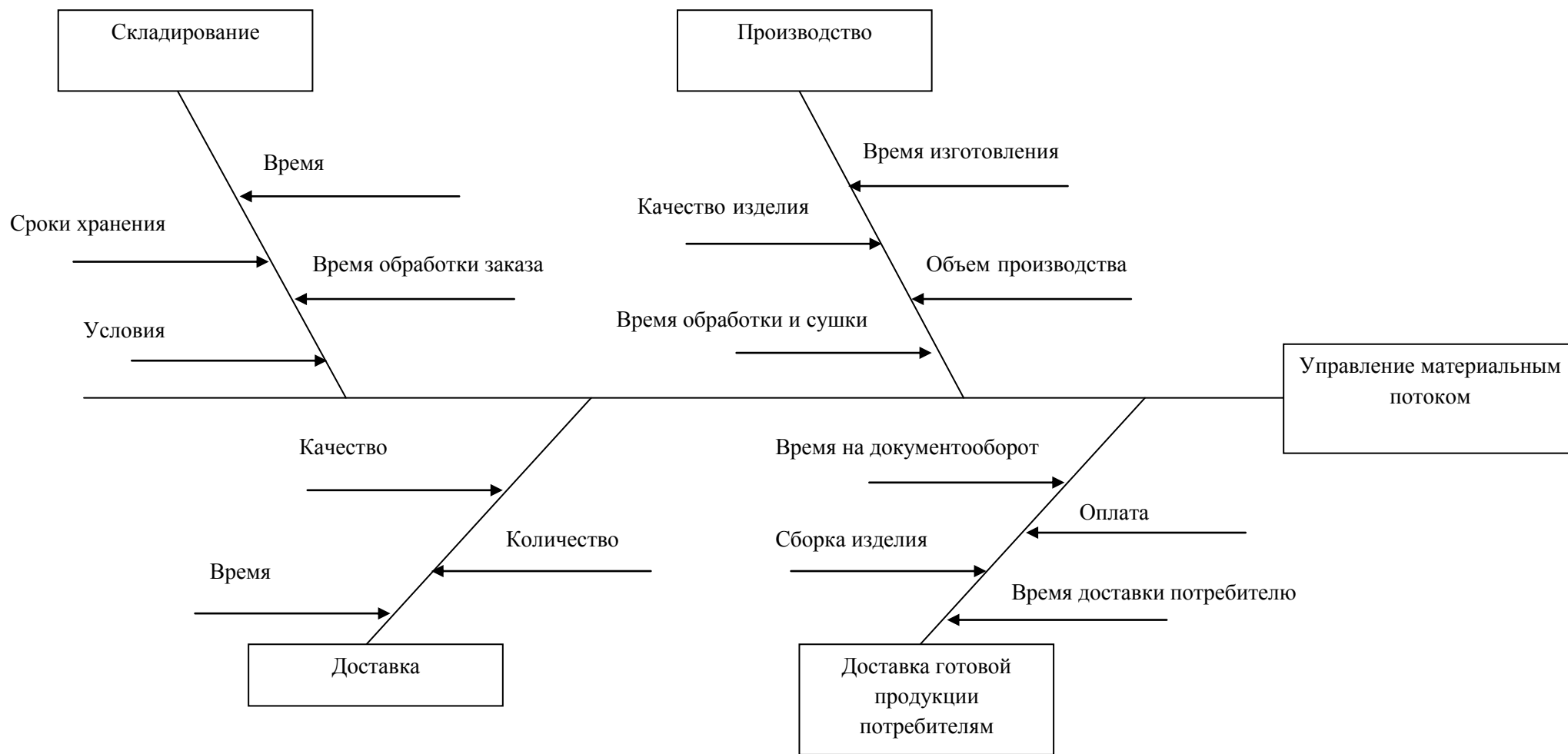
Рисунок 2.3 - Диаграмма Исикавы управления материальным потоком в производстве изделий из дерева
