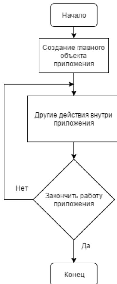
Рисунок 3.2 - Глобальный цикл QT Creator
