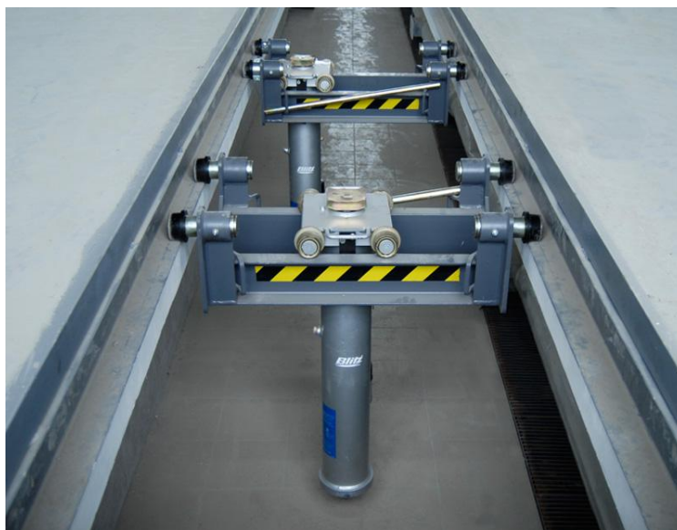
Рисунок 2.3 – Элементы гидropодъемника ремонтного отделения
