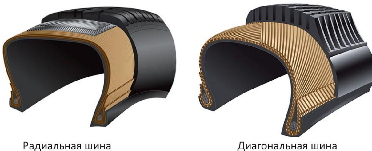
Рисунок 3.2 - Схема расположения нитей каркаса автомобильной шины
