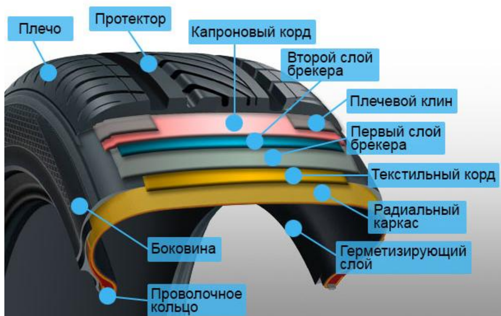
Рисунок 3.1- Схема составляющих частей автомобильной шины
