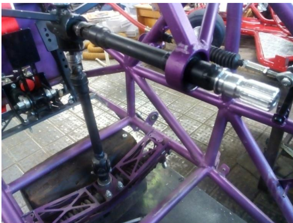
Рисунок 56– Рулевой узел в сборе на болиде 2017 года
