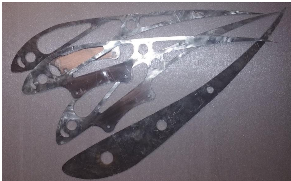
Рисунок 28 – Шпангоуты из алюминия, толщиной 2 мм
