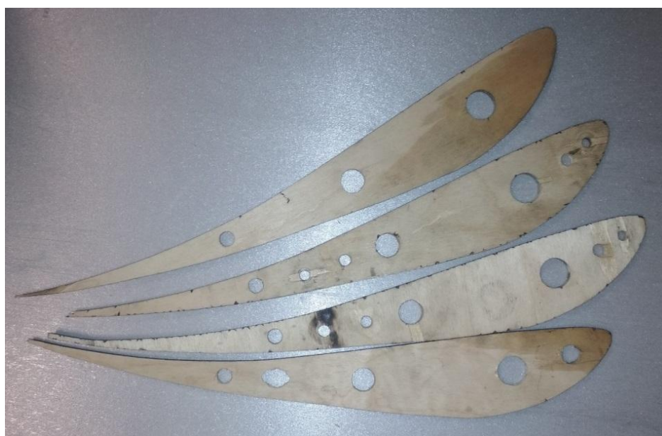
Рисунок 29 – Шпангоуты из фанеры, толщиной 6 мм
