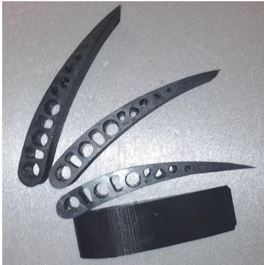
Рисунок 30 – Шпангоуты, напечатанные на 3D-принтере
