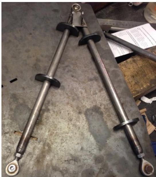
Рисунок 35 – Технологическая оснастка и рычаг подвески
