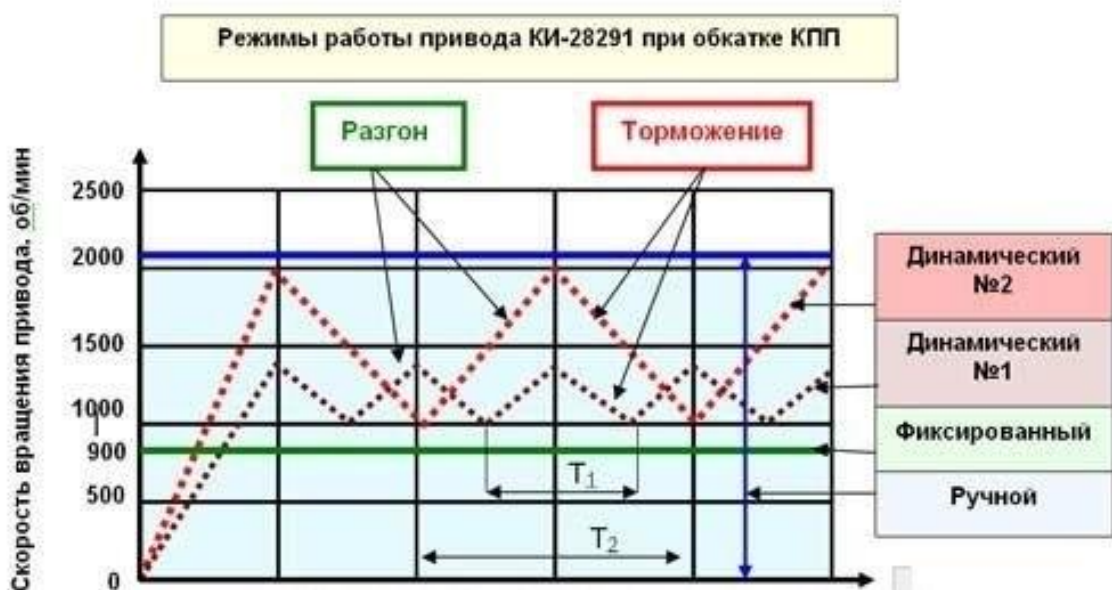
Рисунок 3 – Схема работы станда для обкатки КПП и РК КИ-28291
