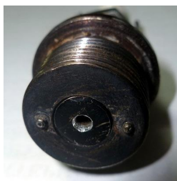
Рисунок 2.1 – Схема камеры сгорания одноцилиндровой установки УИТ-85 (а), где 1 – свеча зажигания в корпусе с датчиком давления; 2 – датчик давления Kistler, 3 – ближний датчик электропроводности пламени; 4 – центральный датчик электропроводности пламени; 5 – дальний датчик электропроводности пламени; (б) общий вид переходника с датчиками ионизации
