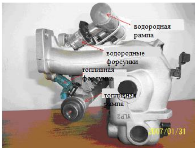
Рисунок 1.9 -Бензиновые и водородные, топливные рампы и форсунки, установленные на впускных коллекторах.
